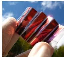
透明な紙と銀ナノワイヤを使うと、軽量で折り畳み可能な透明導電膜ができます。この材料を使って、透明配線やペーパー太陽電池を開発しました。将来の太陽電池は、ポケットやリュックに入れて持ち運べるようになるかも知れません。
