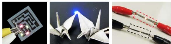
ナノペーパーは、200℃@大気で加熱可能なので、金属ナノ粒子インク・金属塩インク・金属ナノワイヤインクなど多種多様な導電性インクで導電性配線を作製可能です(左)。
