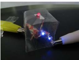
透明な紙に銀ナノワイヤを塗布すると、電気が流れるようになります。その透明性と導電性は、ITOガラスに匹敵します。
