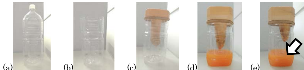
写真 1 (a) 空の PET ボトル (1L または 1.5L) を用意 (b) 上側を切りあける。 (c) 2枚重ねのストッキングを PET ボトルにセット。 (d) 濾過している間は、触らず放置。15分ぐらい。 (e) ストッキングから出てきた液体を回収 (矢印)
